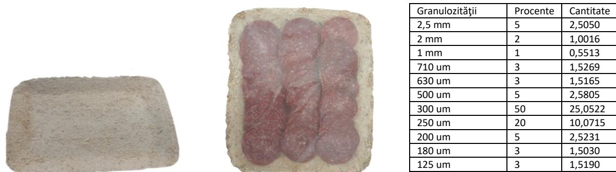
Figura2. Tăvițe biodegradabile din amestec de fracțiuni rezultate la măcinarea cojilor de semințe de floarea-soarelui
